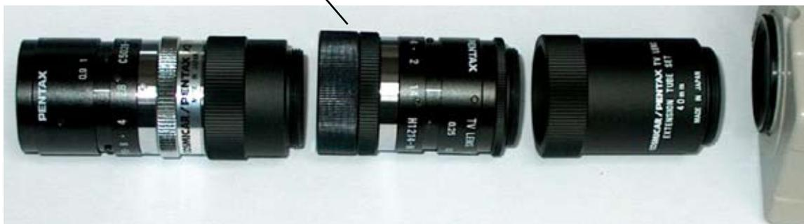
Cette configuration, sans la bague d'extension de 40mm ne permet d'obtenir « qu'une » focale de 290mm.
