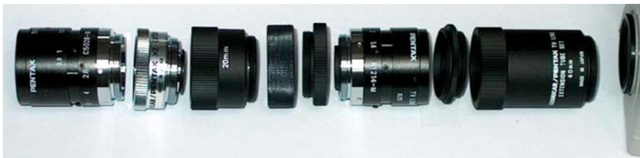
Voici un nouveau schéma présentant les groupes avant et arrière vissés avec leurs différents éléments. Au milieu se trouve une bague d'adaptation Monture C-C de 10mm, qui permet de lier le groupe avant au groupe arrière.
